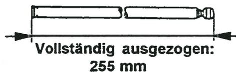
Die Gesamtlänge des 6-teiligen Ersatzteleskops beträgt 220 mm, daher ist vor dem Einsetzen des Teleskops in die Motorantenne die Distanzhülse, wie in der Abb. gezeigt, unten vor das Teleskop zu schieben. Die Distanzhülse ist dem Ersatzteleskop beige packt.
