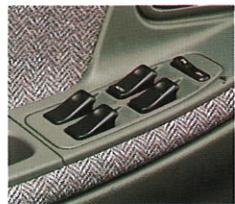
Sicherheitsorientierte Mazda-Technik: Das elektrisch betätigte Fenster (ab GLX-Ausführung) schließt erst, wenn der Schalter angehoben wird.
